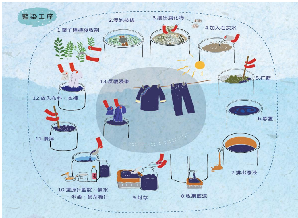
図5：本プロジェクトが作った藍染工程
