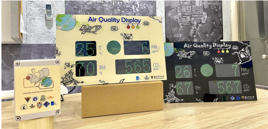
圖：(1)本計畫大氣系學生團隊研發之空污燈。由左至右，分別為偵測器、與左側之偵測器即時連動的顯示面板，以及偵測器與顯示面板合裝的即時即地即見空污燈。照片由本校大氣系提供。
